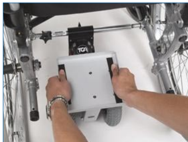
Fig. 4 Fastgørelse til tværstang.
